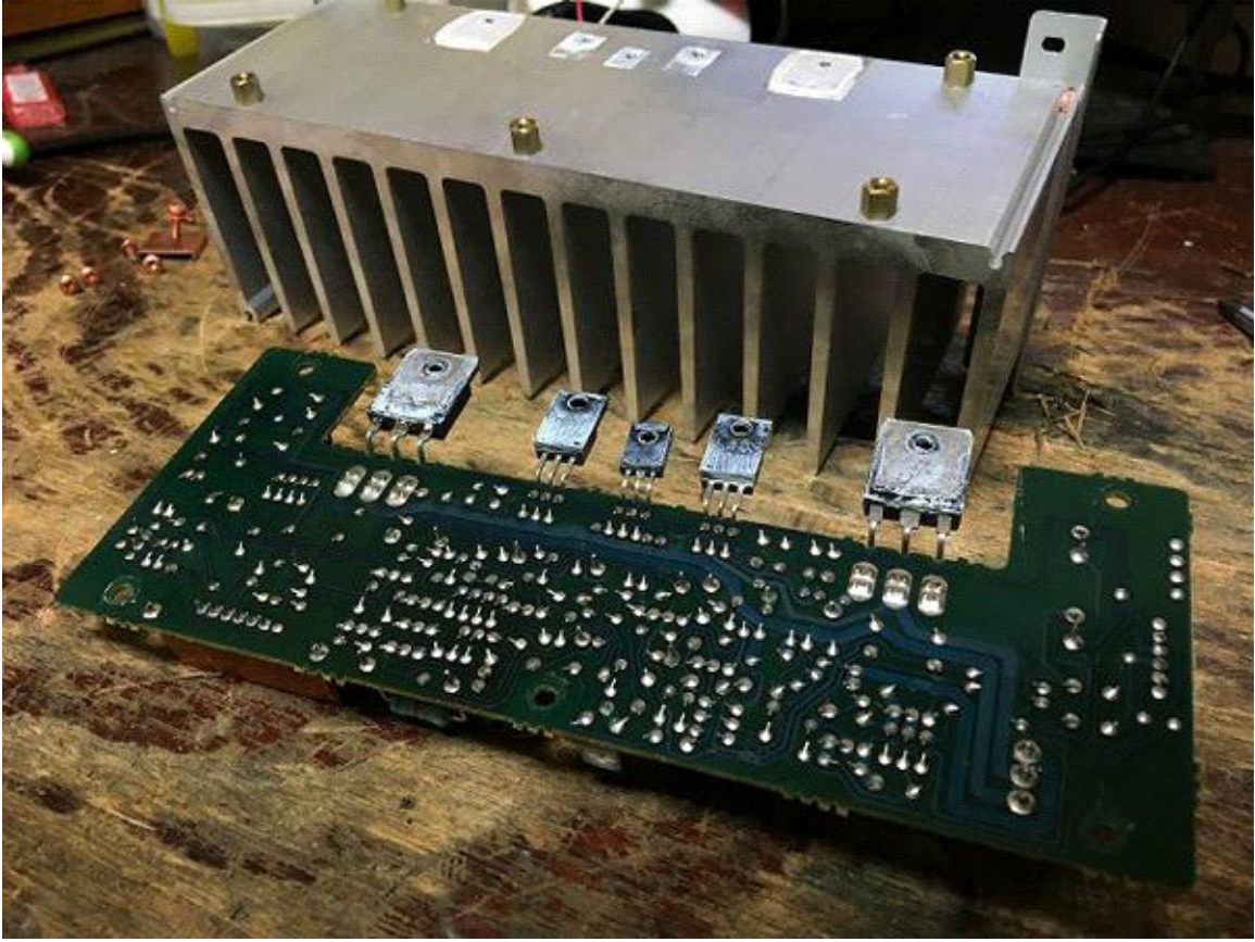
初段ドライバーユニット修理中
