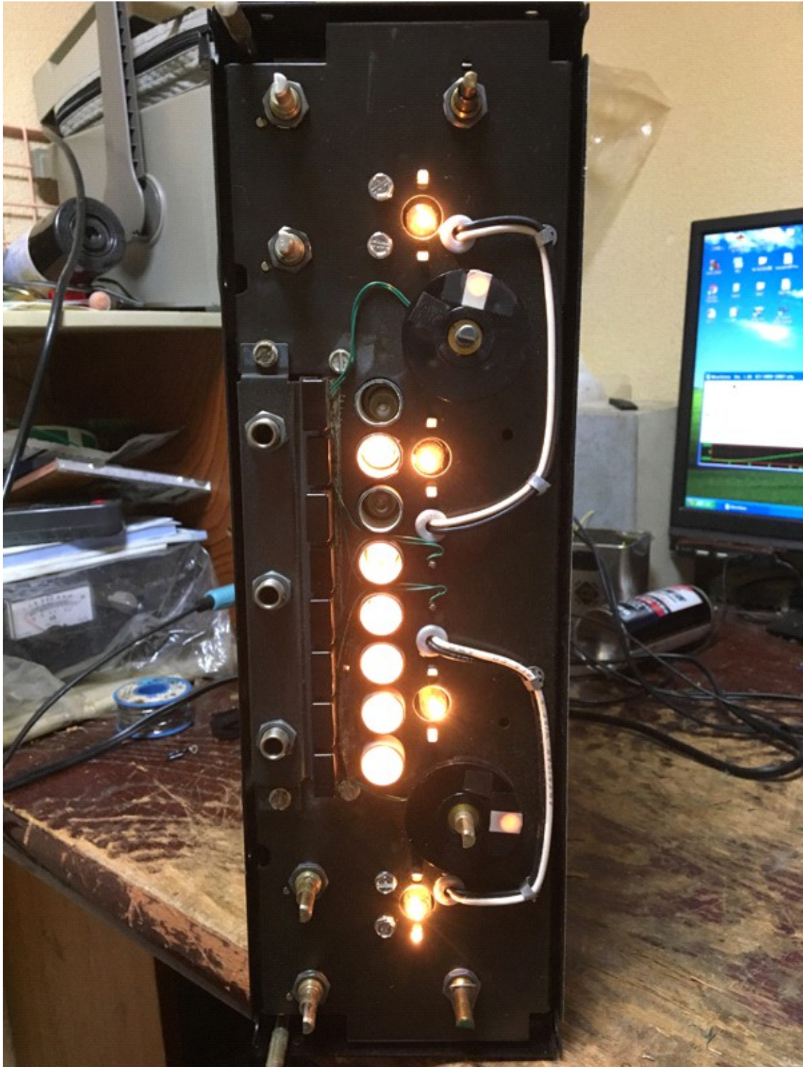
inputセレクターの接点清掃
