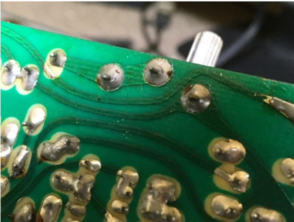
コンデンサーの液漏れによりはんだが浸食されて導通していない
