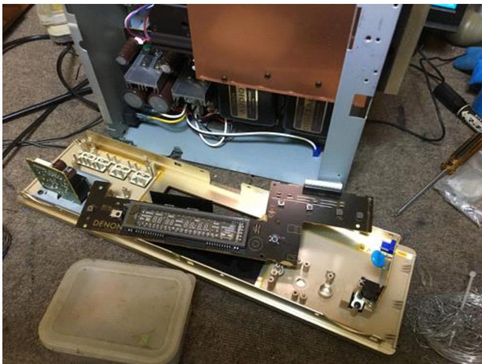
液漏れコンデンサーを交換する（読み込み不安定の原因）
