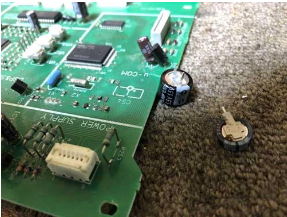
メモリー用蓄電池の交換をする（腐食除去済）
