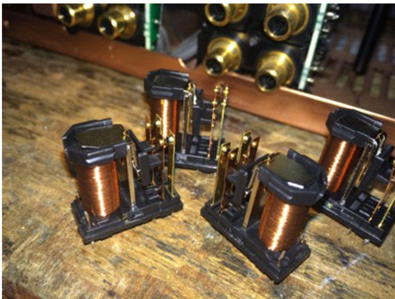
接点清掃後、コーティング剤をして密封
