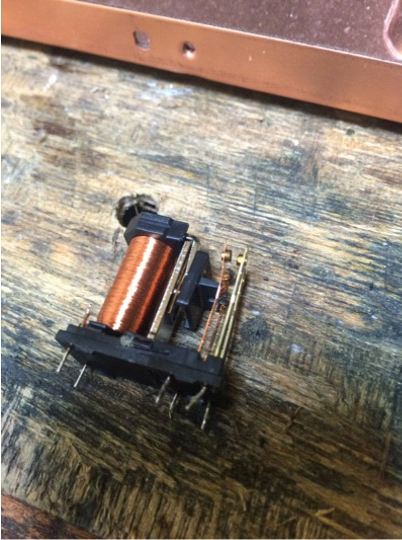
汚れ具合（全リレーに黒くカーボンが付着） スピーカーの切替方法が悪かったと思われる。
