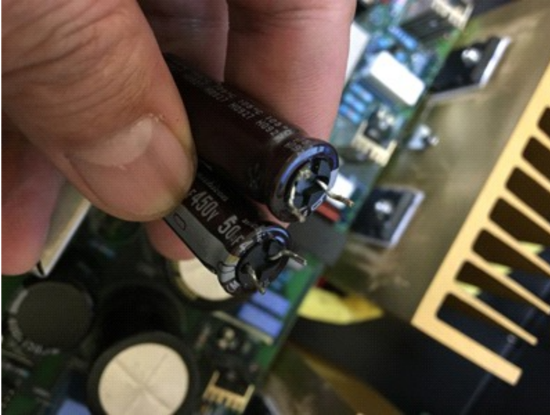
コンデンサー取り外し、基盤部分に電解液が付着
