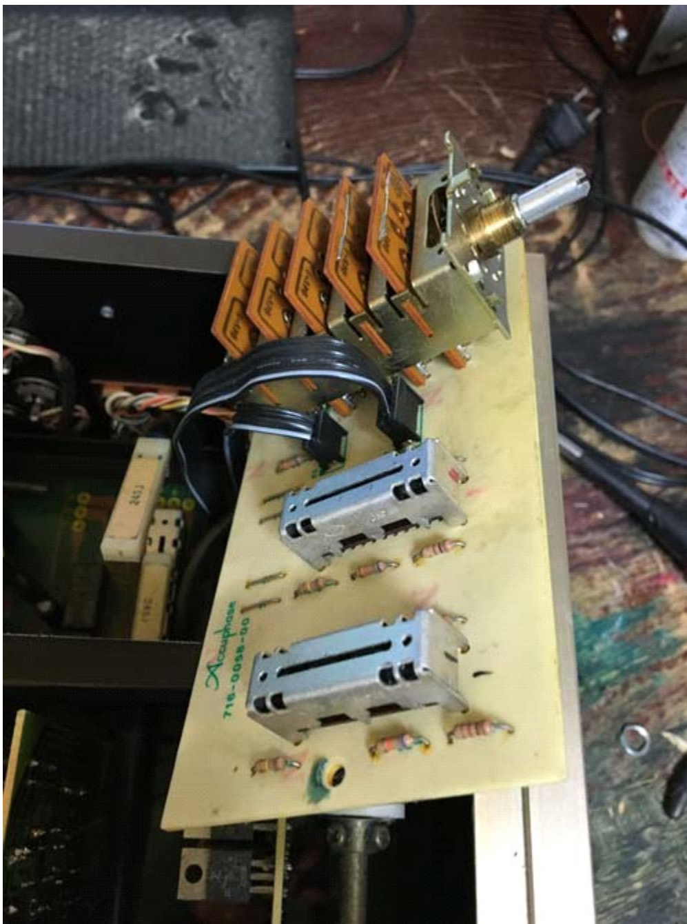
各アンプユニットの状況の確認と接点の清掃
