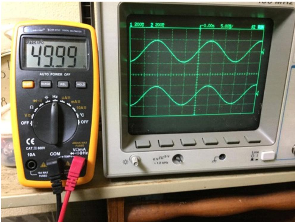
50Hzのトーン最大の波形
