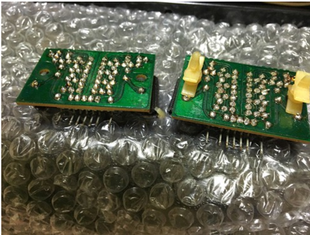
フォノイコライザーのはんだ修理（ノイズ発生と電位が異常のため）
