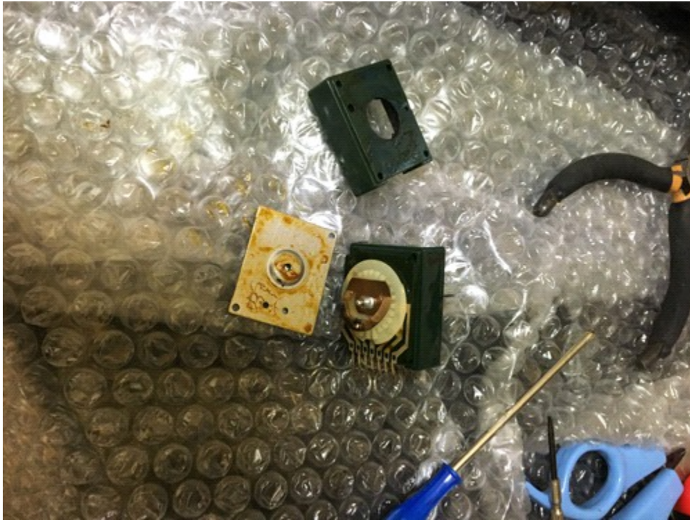
フォノイコライザーのはんだ修理（ノイズ発生と電位が異常のため）
