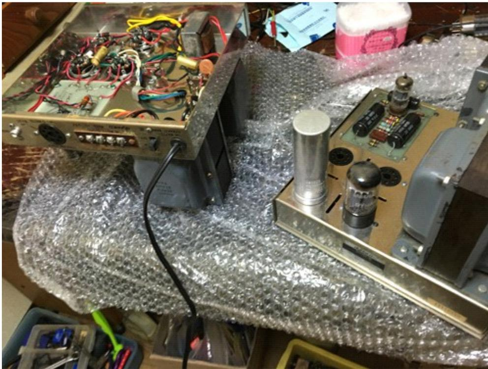
劣化部品の交換（フィルムコンデンサー 6 個、電解コンデンサー 2 個）
