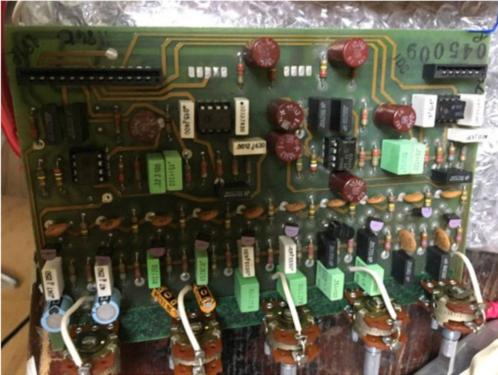
コンデンサーの容量抜けのため交換
