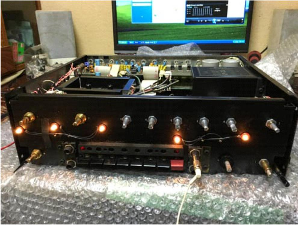
電源用コンデンサーが劣化していますが、オリジナルの物を交換すると音質に影響があるため、気休めで追加
