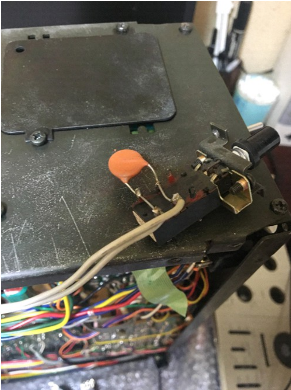
電源スイッチの劣化コンデンサー
