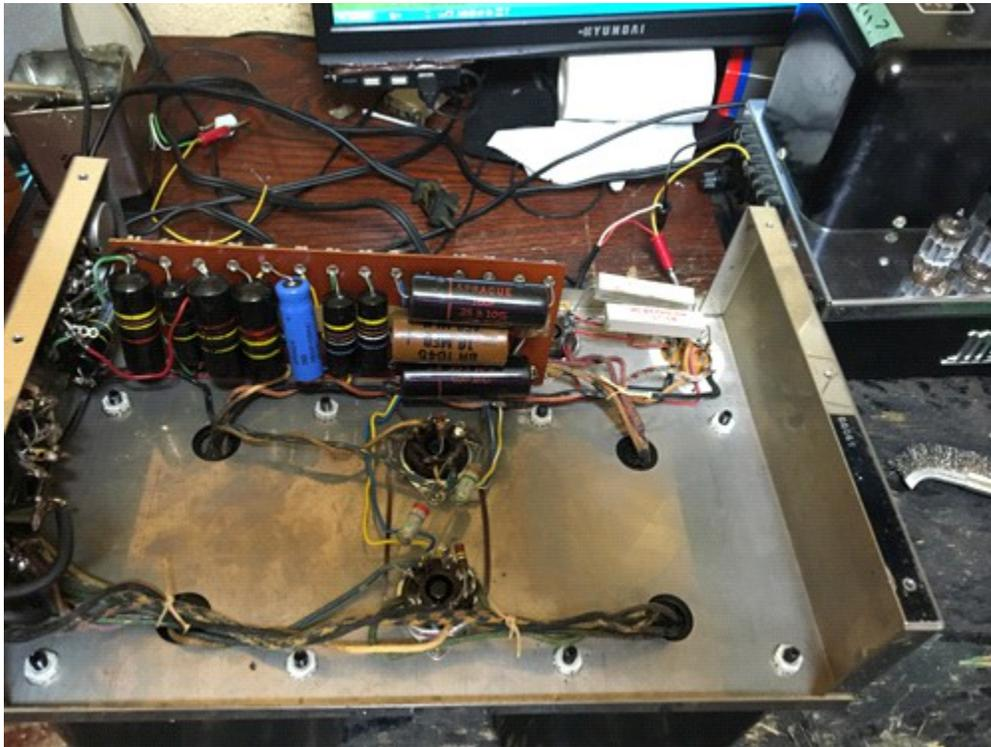
出力が変なので初段の真空管交換
