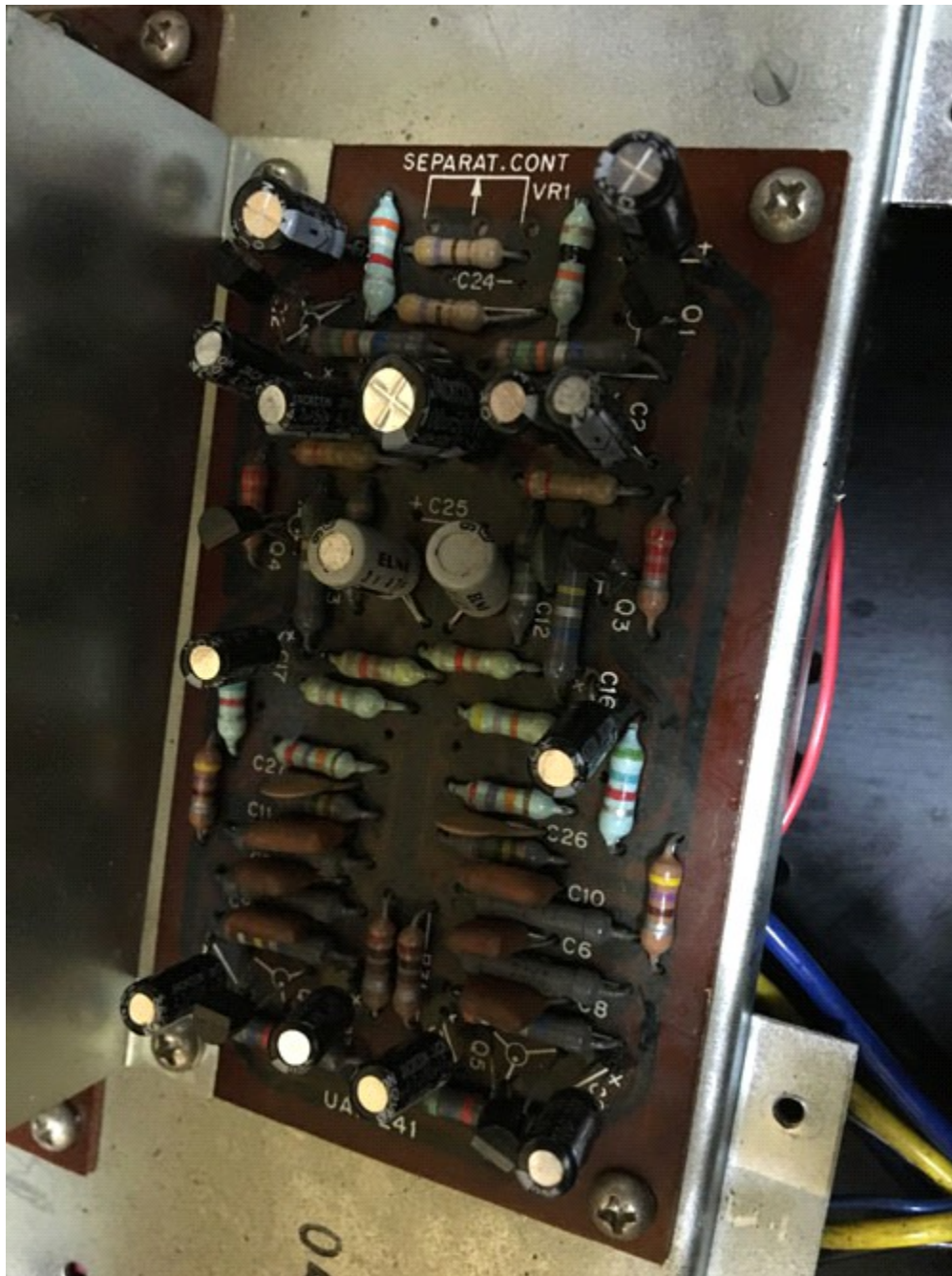
劣化TR、コンデンサーの交換
