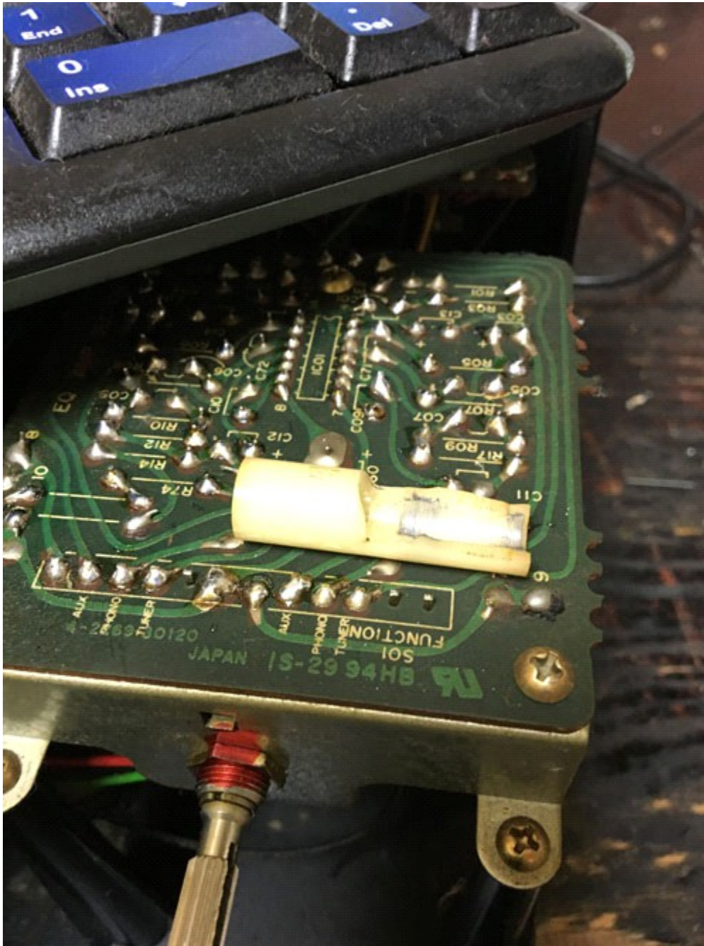
ファンクションシャフトの部品破損箇所
