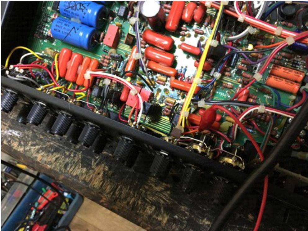
ドライブ用のポットの配線も接触不良
