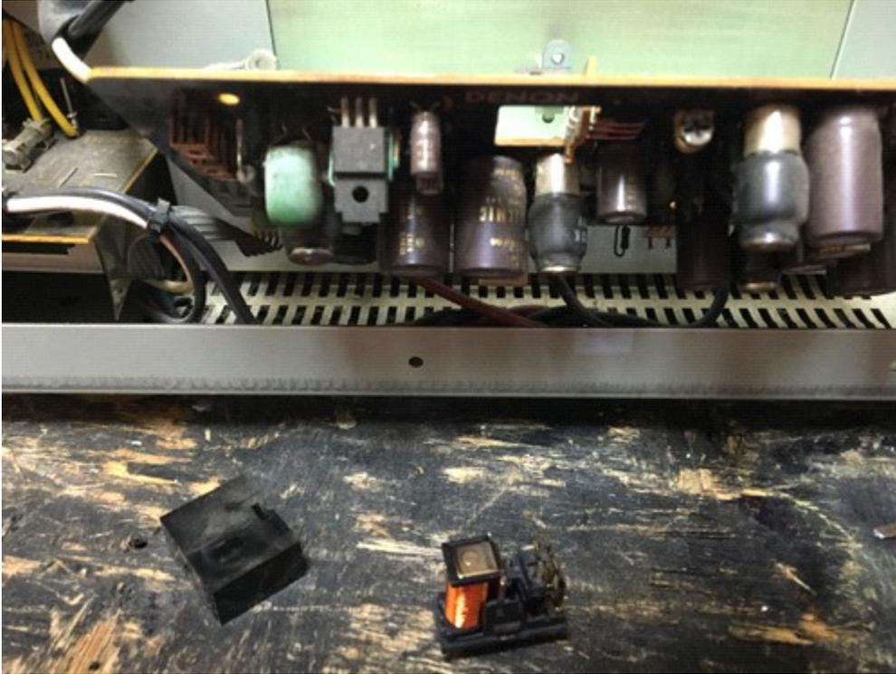
左側CHアンプ基盤分離、両CHとも事故歴なし、オリジナルのMOSFETが付いてる
