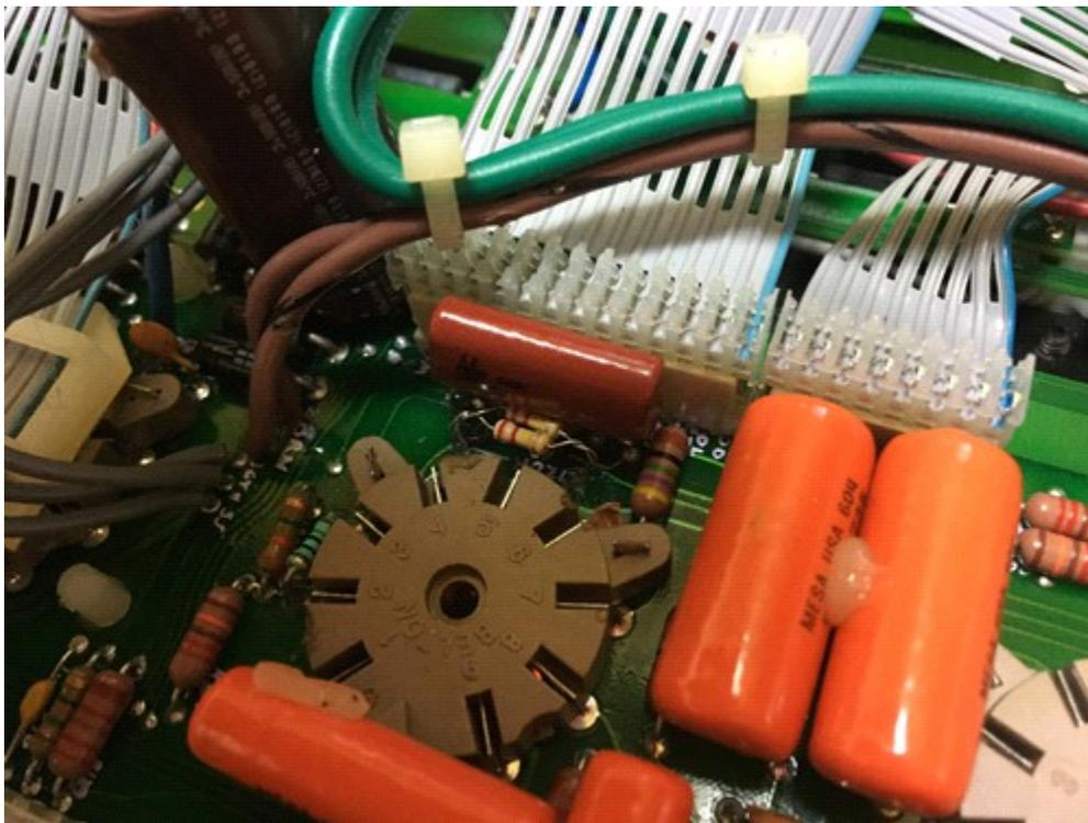
液漏れのためコンデンサー交換
