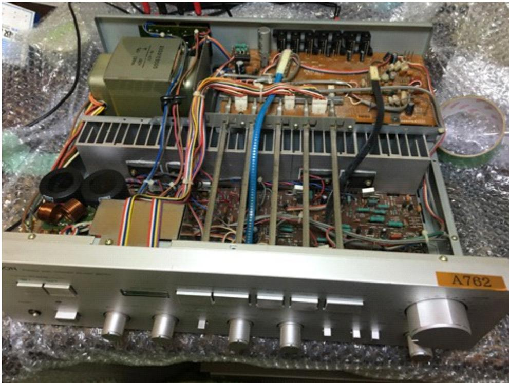
パワーアンプ部のはんだクラック修正、予防策にセレクター基盤のはんだも修正
