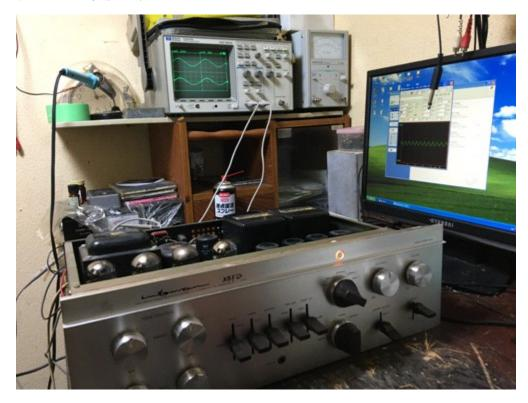
最大時の波形 23W+23W  $8\Omega$  1000KHz 50CA10の真空管は寿命が近い
