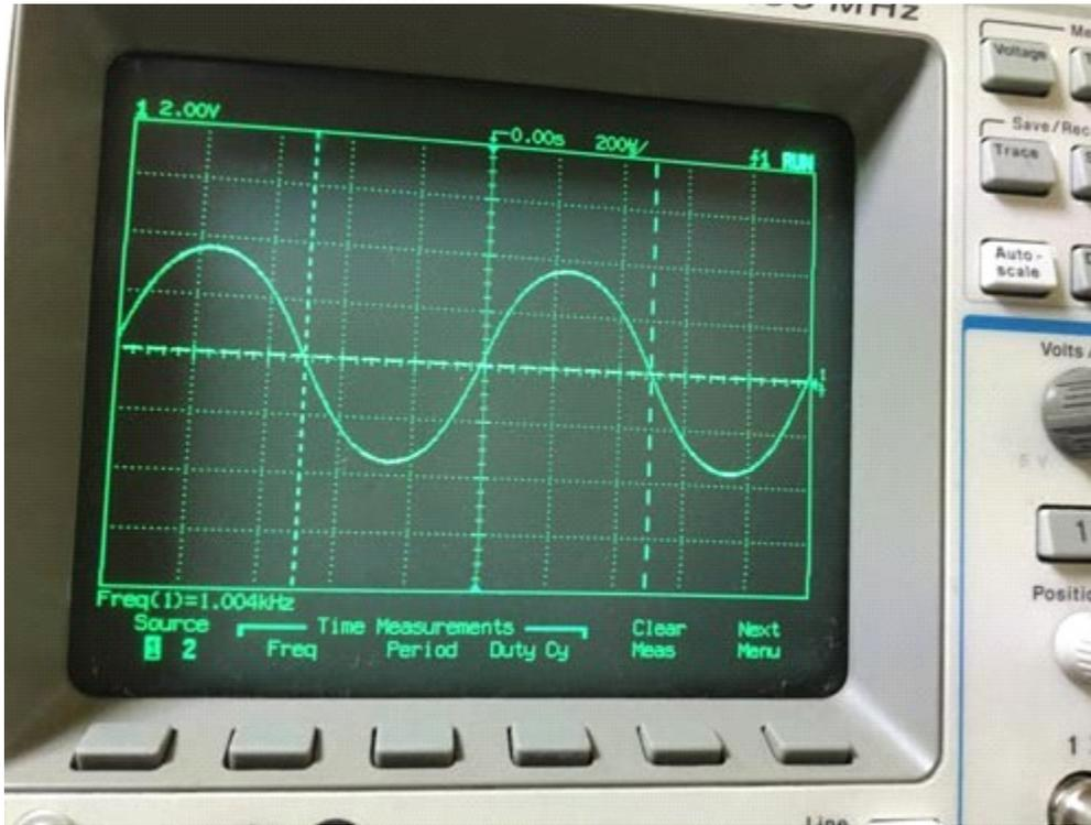
4KHz 360W時の波形（イコライザーの関係で高音部分が弱いので、トーンを少し上げている）
