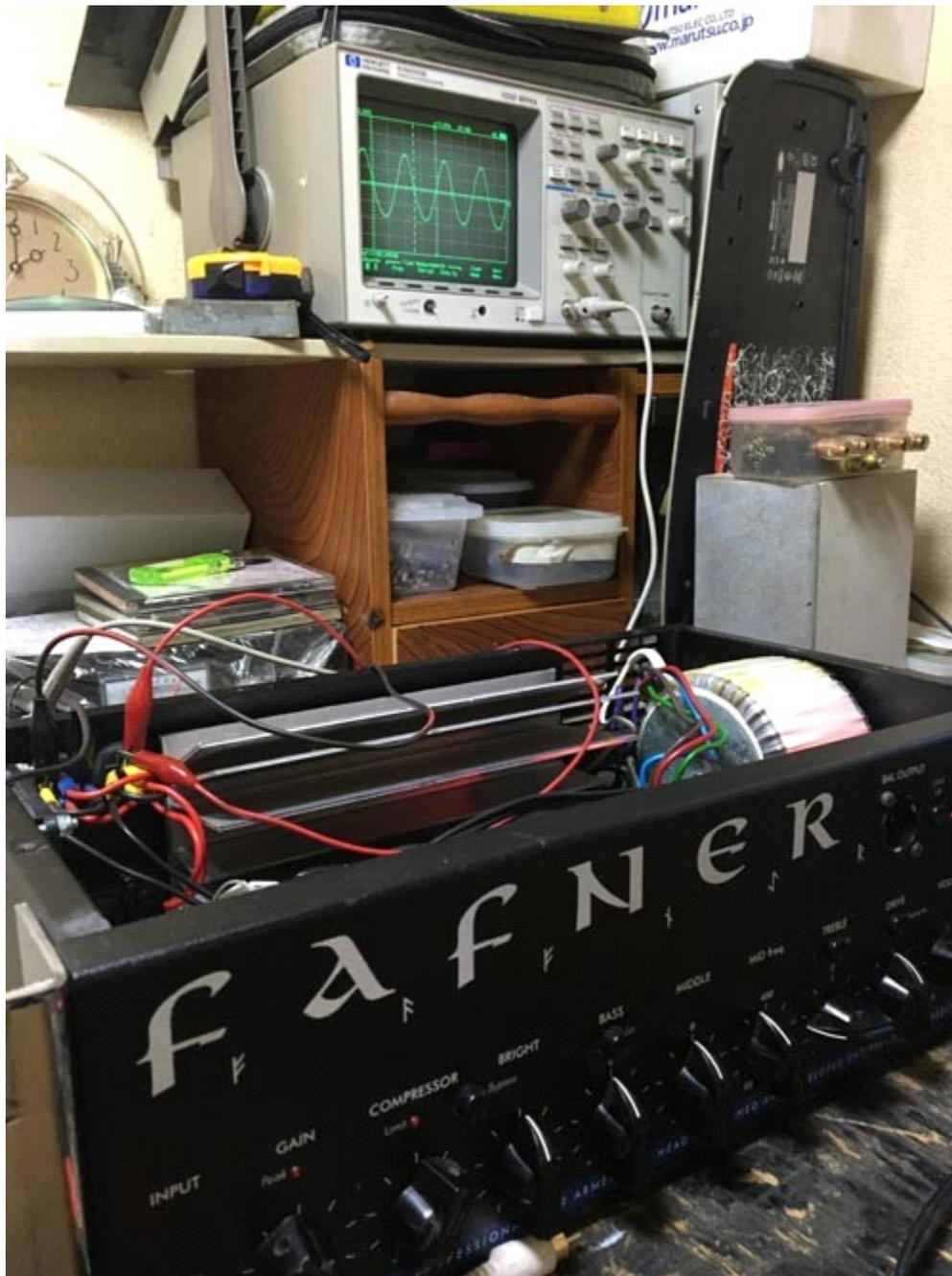
16Ω 360W出力時 (76V出力、約360W)
