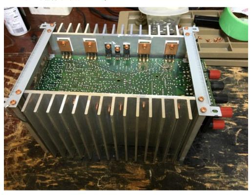
電源などの回路も修理してからの動作確認(AB級のアイドル調整から)
