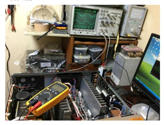
クラスA側の動作確認 1KHz 30W 1KHz
