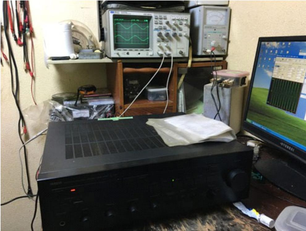
28.5V 1KHz 8Ω出力@ 101W+101W
