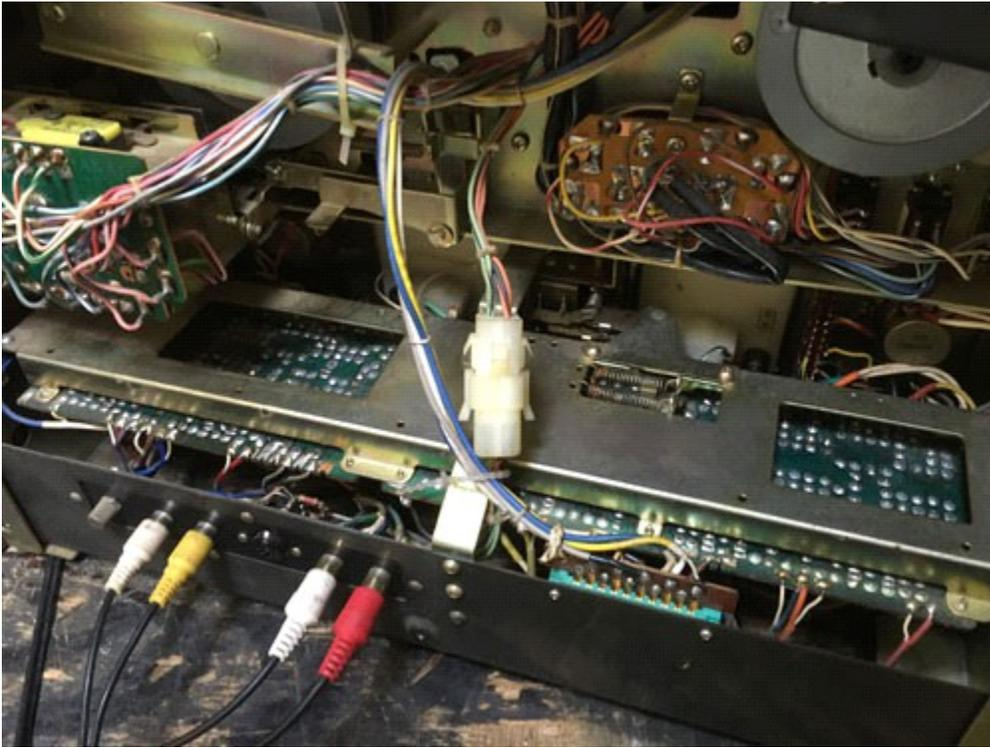
劣化トランジスタ交換、RECスイッチの接点清掃、テープ走行系の清掃をする
