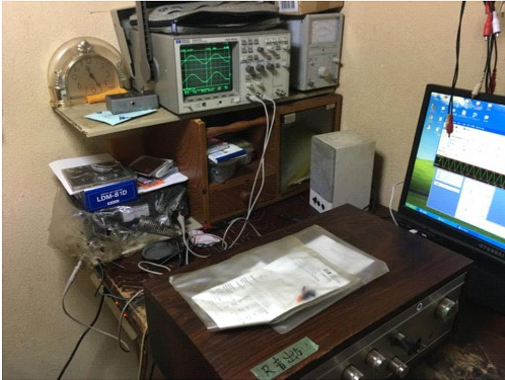
左右の波形 (20W+20W 8Ω負荷 1kHz)
