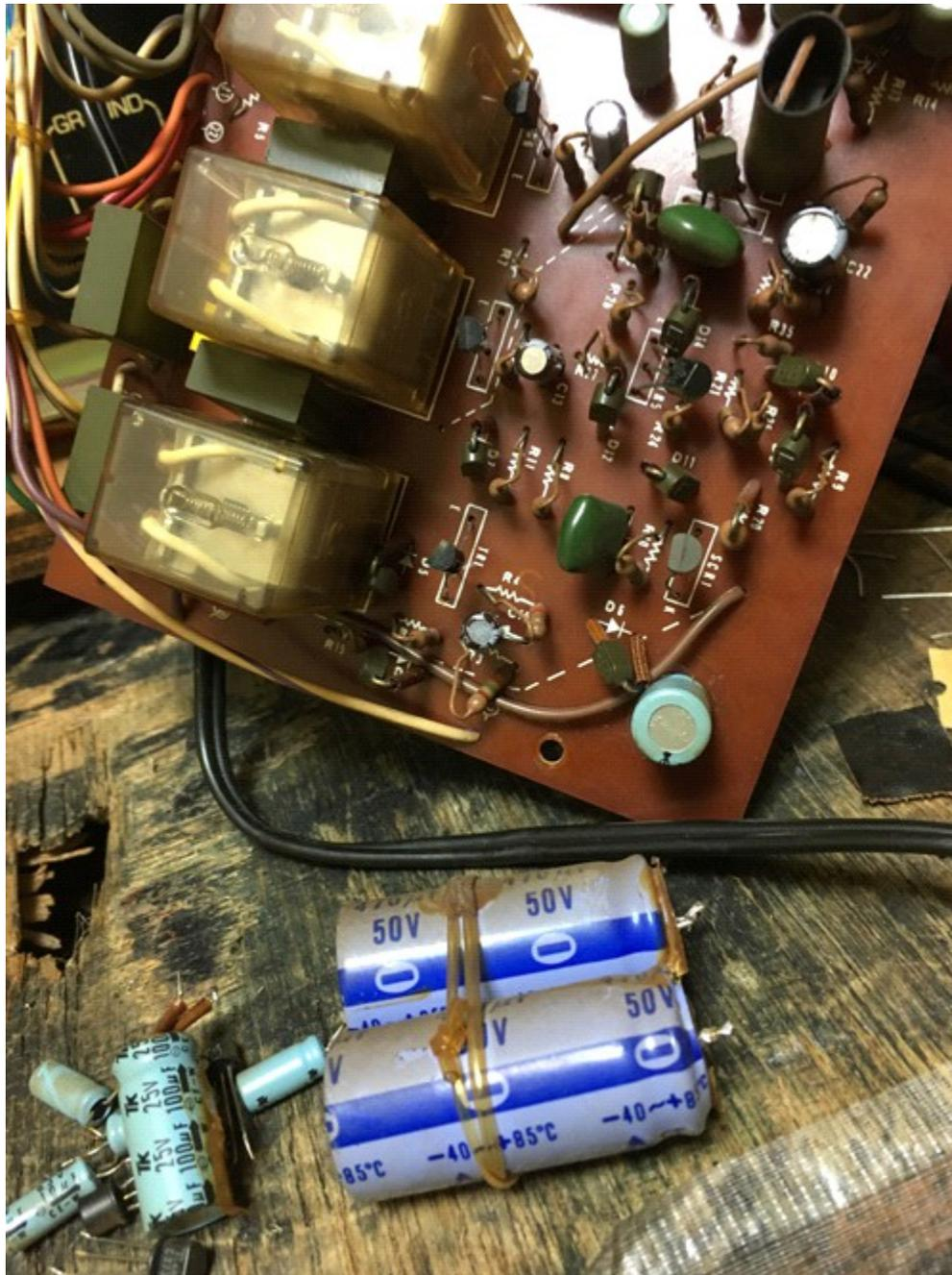
録音アンプや再生アンプ、ラインアンプなどの共通の電源用コンデンサーを交換する。
