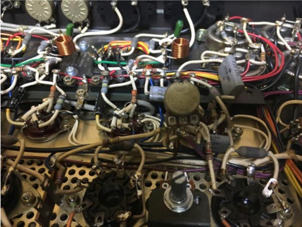
VRを交換して保護抵抗も交換、プリ用電源用抵抗も交換。
