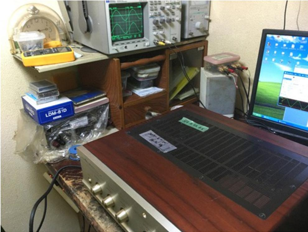
出力確認 (1kHz VR最大時 負荷600Ω)
