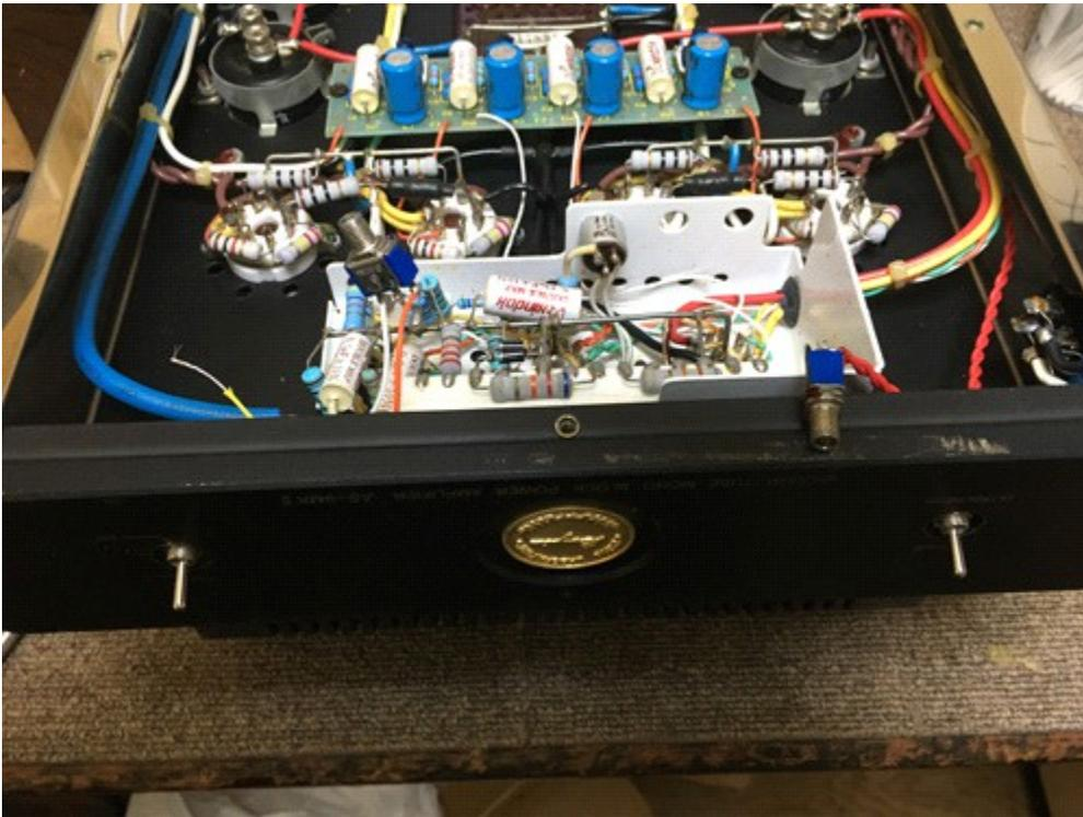
プリ電源用コンデンサーの液漏れ（ノイズあり）
