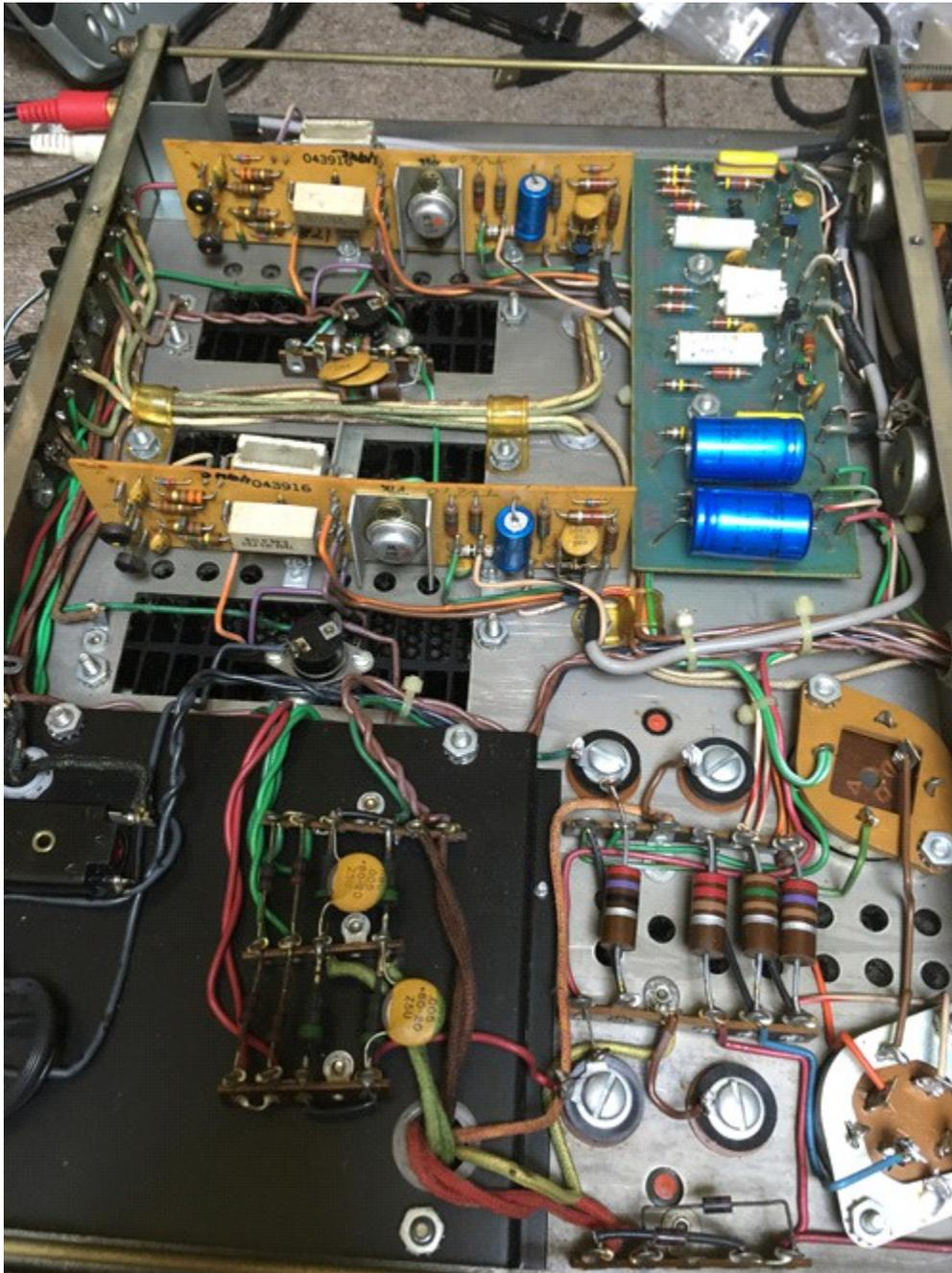
出力端子破損のためC24から移植交換（C24は別の端子に交換予定）
