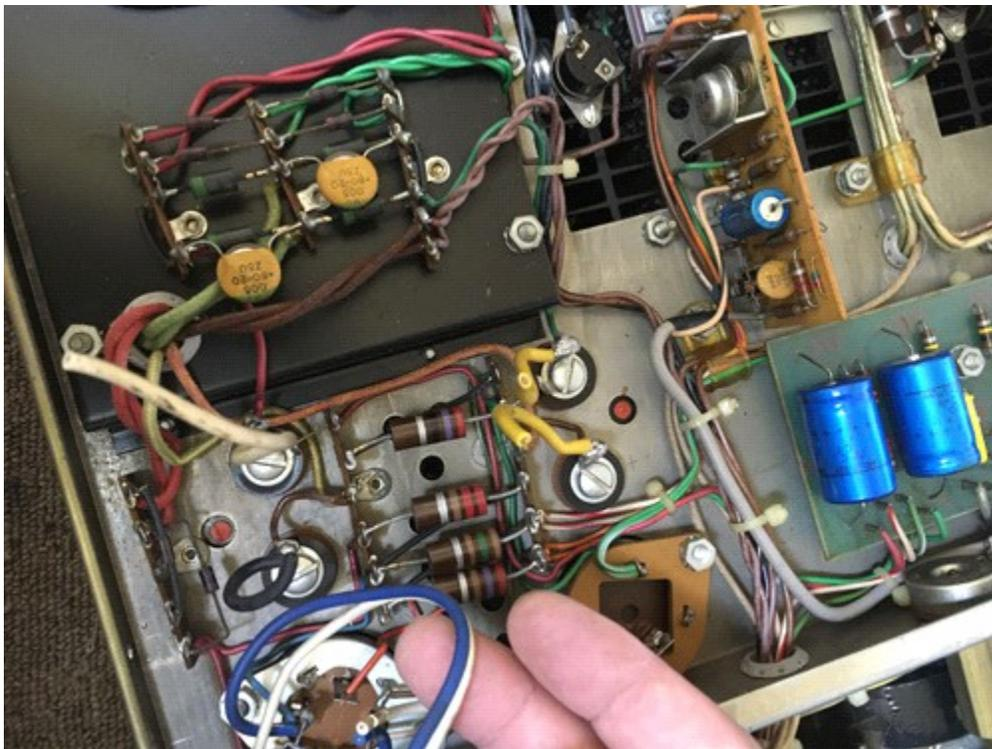
ケーブルの再配線、スピーカースイッチの清掃、BIAS確認など
