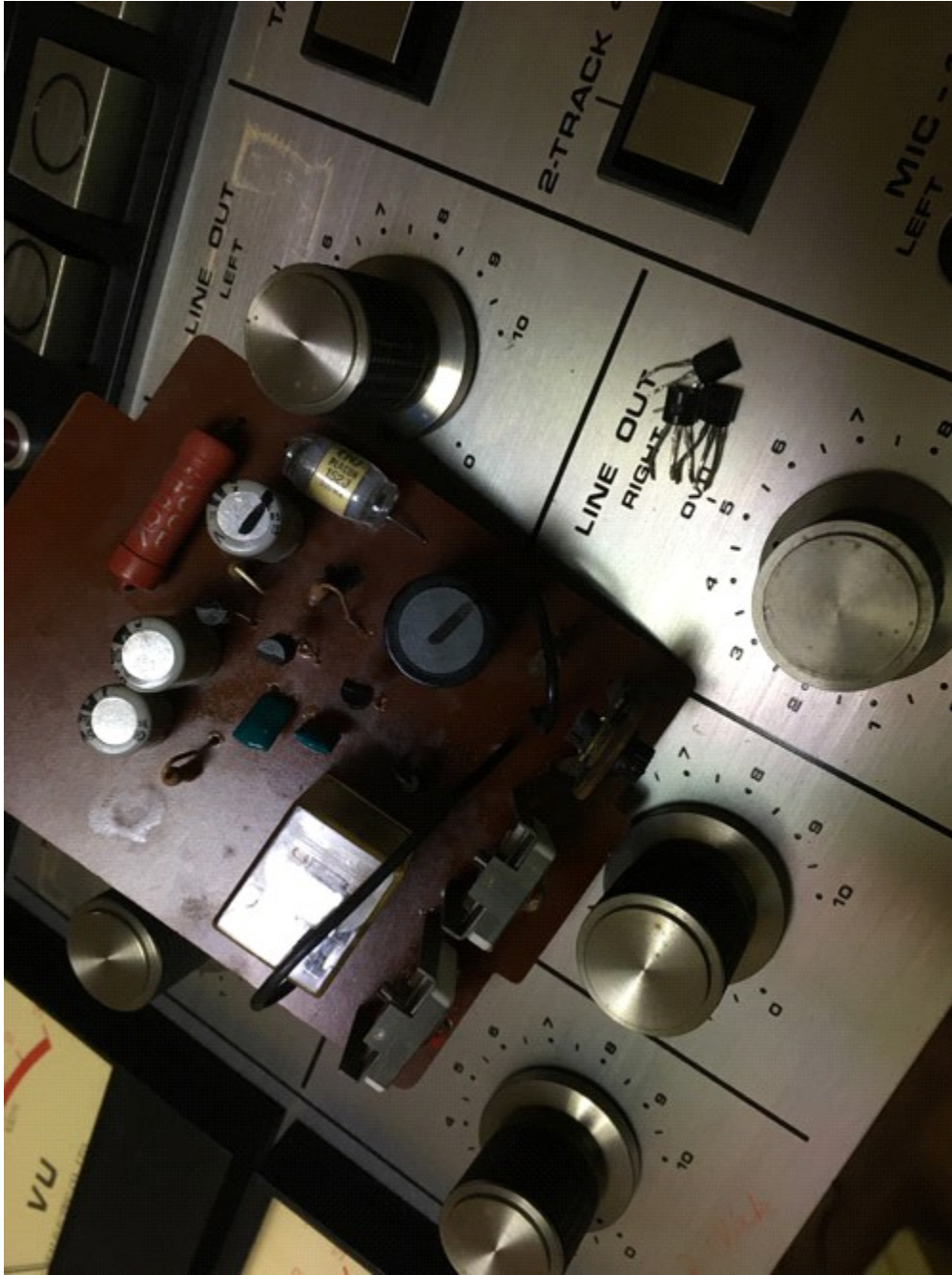
BIAS回路の劣化トランジスタ交換
