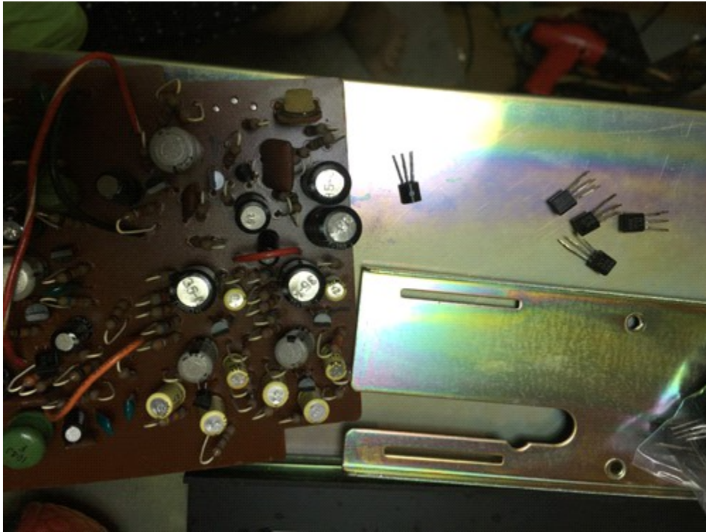
LINEアンプ、録音アンプの劣化トランジスタ交換（左右）
