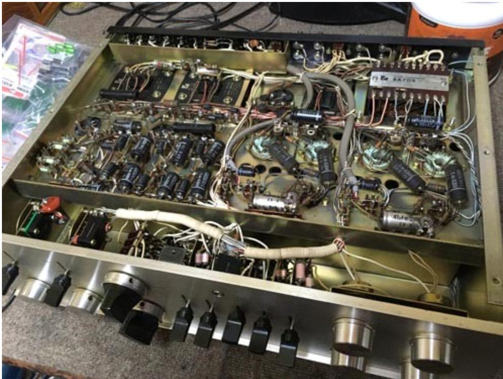
劣化部品の交換をしてBIAS調整を済ませる。
