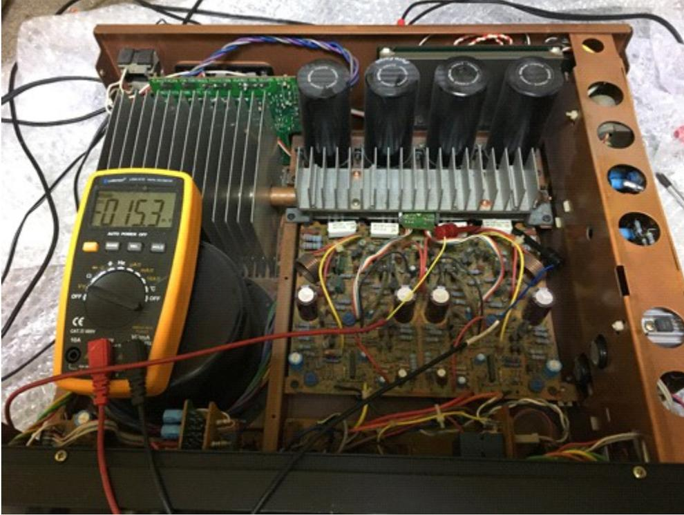
アンプ負荷テスト 100W+100W 8Ω 1KHZ
