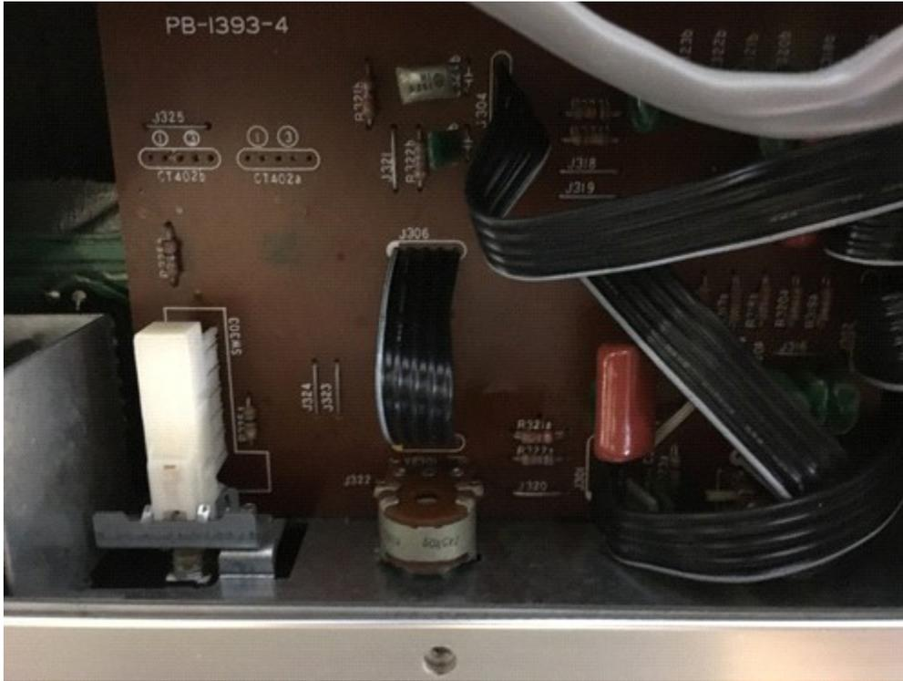
プロテクト回路のはんだ修正（プロテクションが解除しないのでDCバランスなどは事前に調整する）
