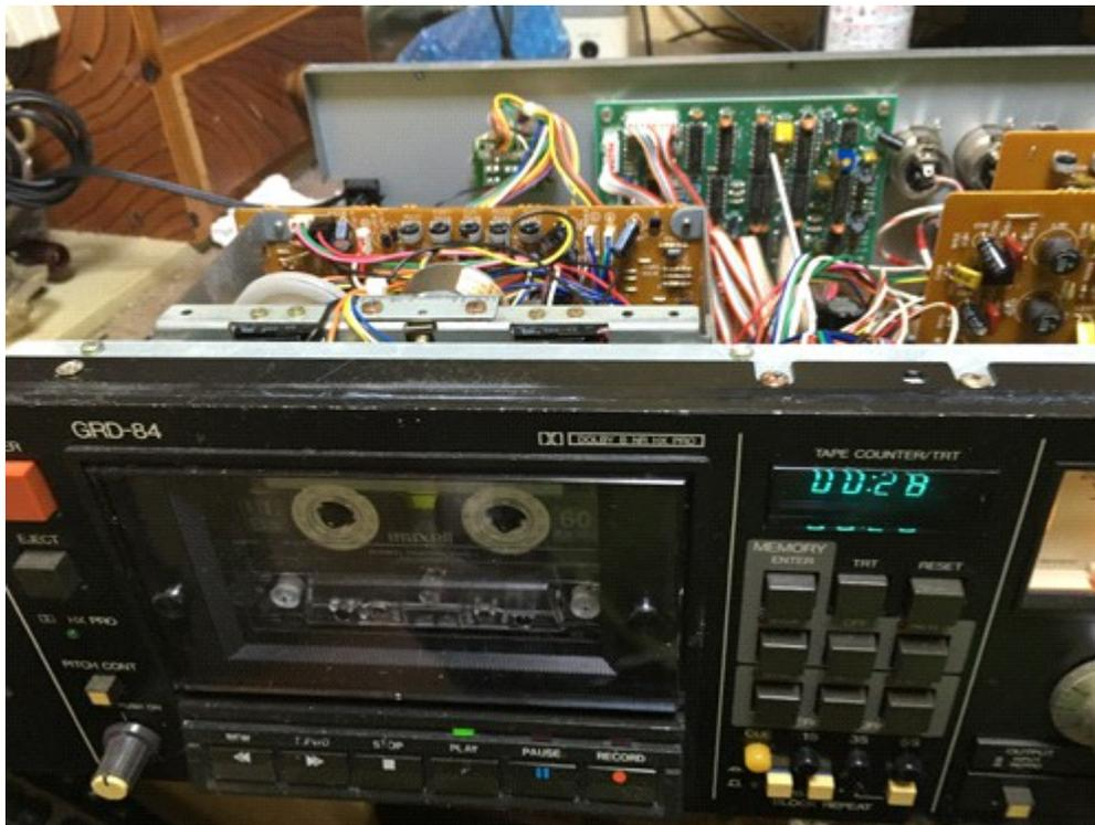
テープスピードの調整、HEADの清掃、ドルビーランプの交換をする
