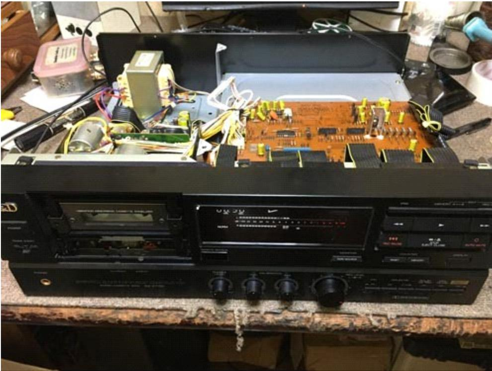
録音時に左右のバランスが異常なのでバランス調整をする（基盤VRにて）
