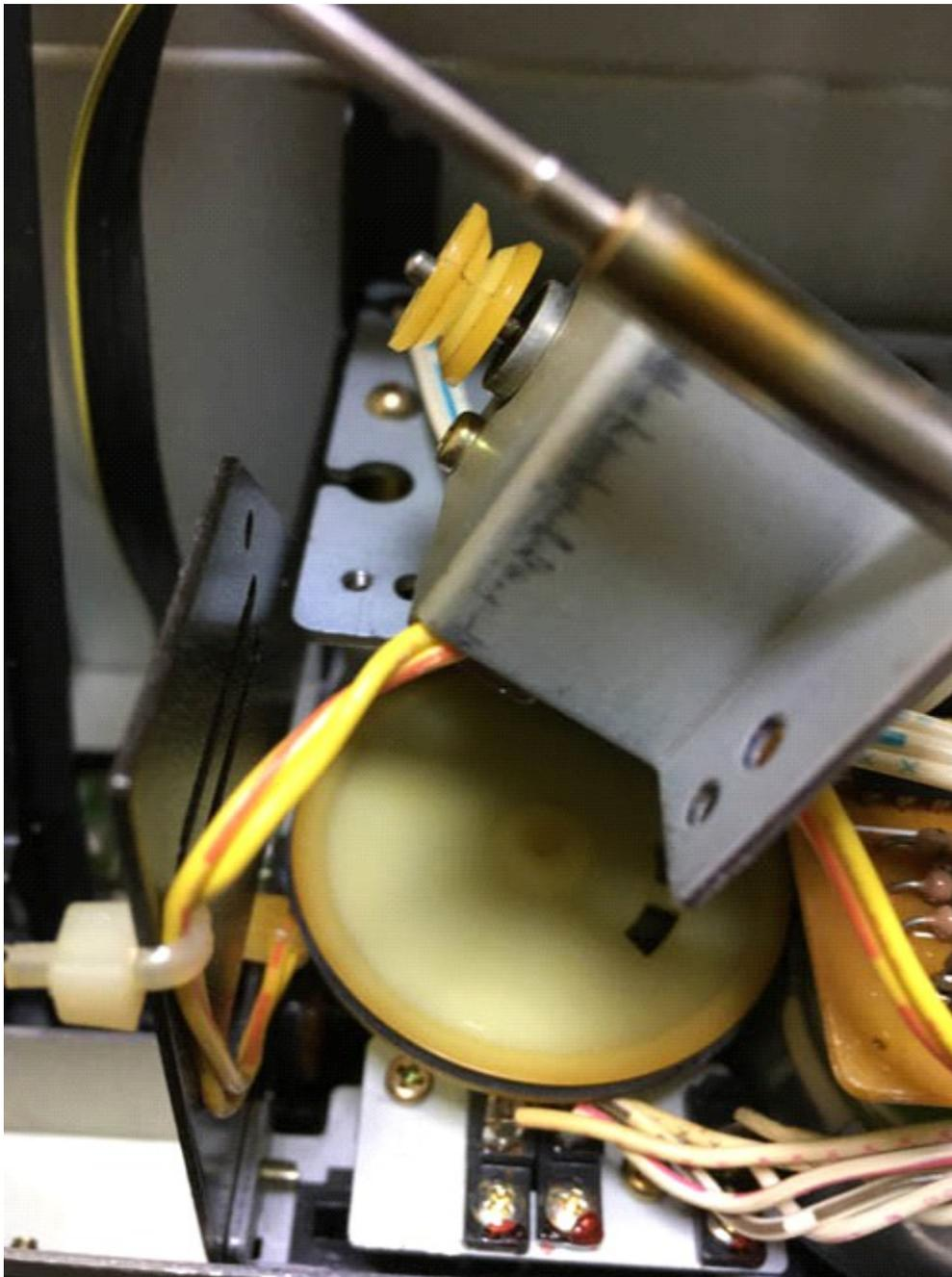
固着したピンチローラーの清掃や録音HEADの断線を修理する
