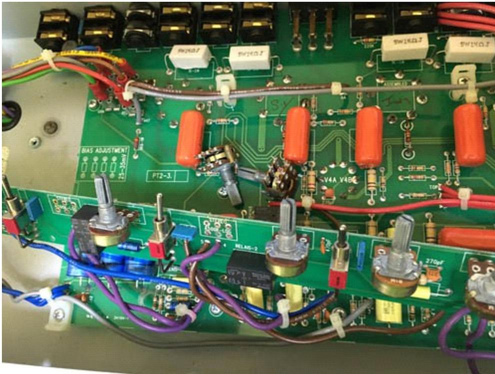
背面端子のジャック折れの部分を交換する
