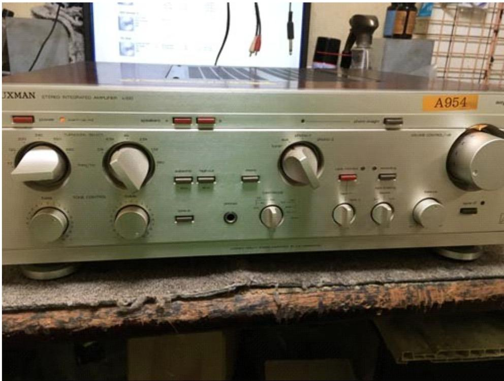
暖機完了後、電源ボタン横のランプの消灯を確認
