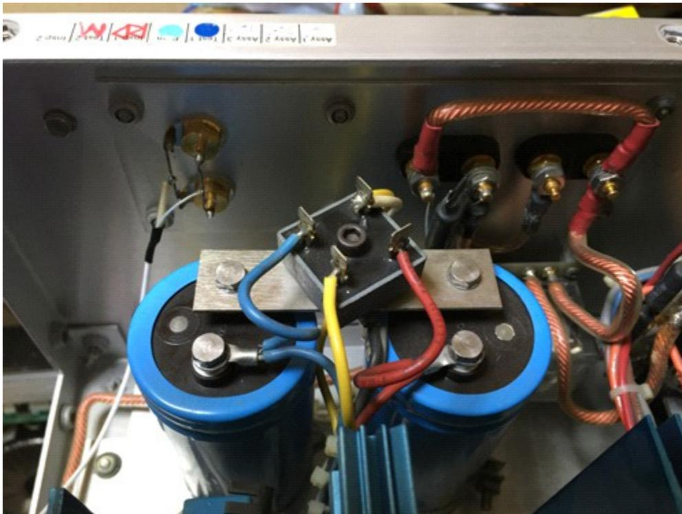
焼き切れた抵抗を交換して確認するもDC漏れがある
