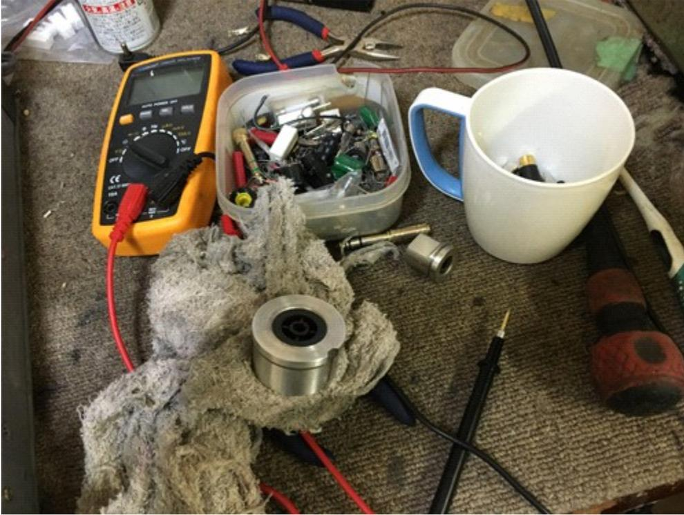
最終段取り付け、アイドル電流を調整する
