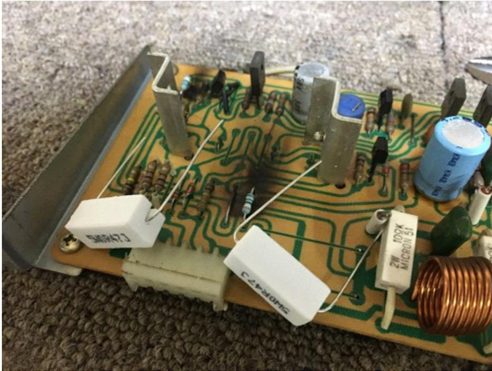
反対側のドライバー基板もトランジスターが故障しているので交換する
