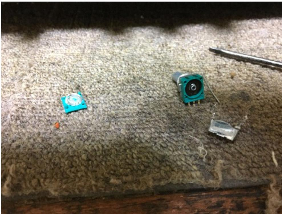
ボリュームを劣化させたコンデンサーを交換する（金色の物）コネクターの接点改善をする
