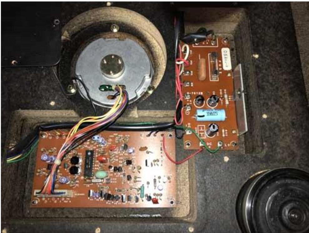
回転35/45時のスタンバイ消灯を確認、レコードを再生して確認する
