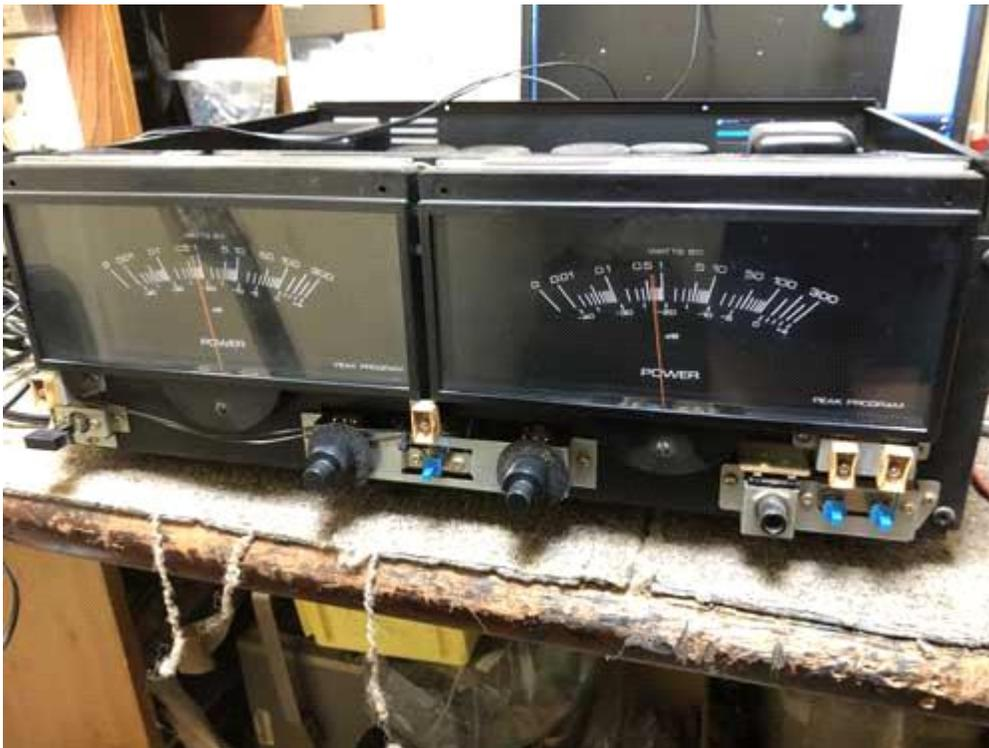
オペレーションランプ（電源、メーターモード、スピーカーA/B）をLEDに交換
