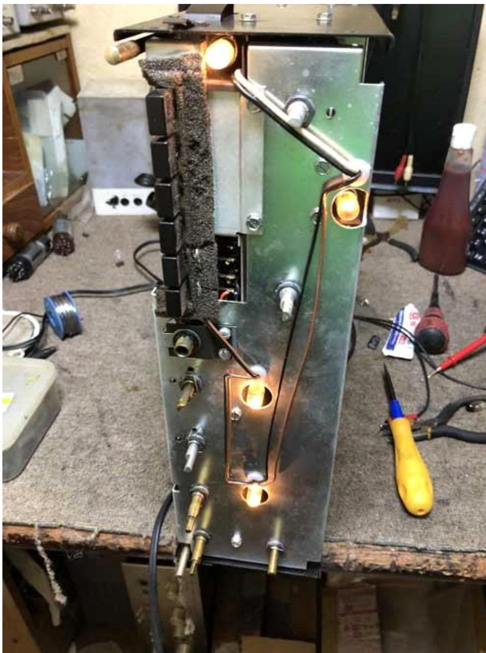
セレクタースイッチやボリュームの接点を改善して電源部のコンデンサーは劣化しているので追加（改造部から安全に使えるものを使用）80Vライン
