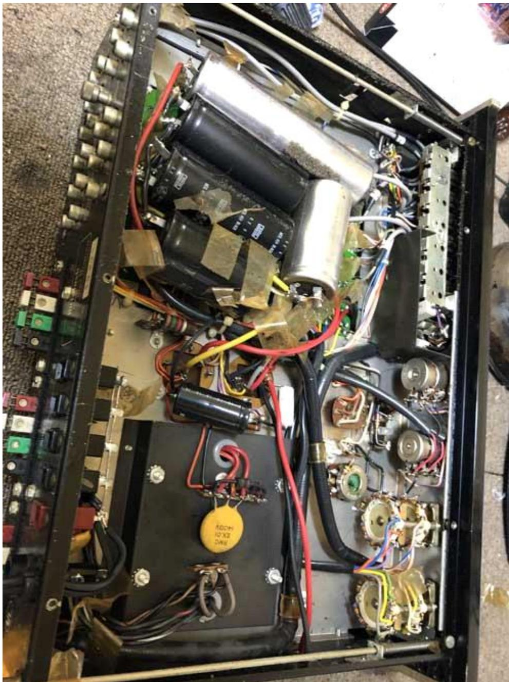
電源回路部分の抵抗が焼き切れている、これだけのコンデンサーを繋げたら設計以上の大電流が流れるのでその影響で焼き切れた物と思われる。
