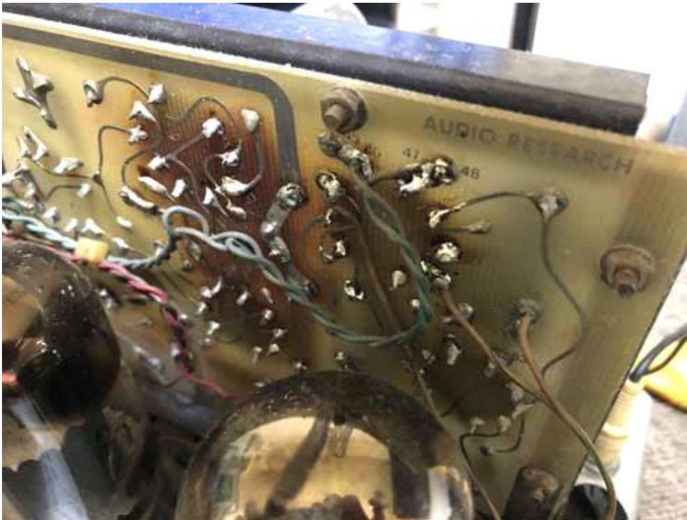
パワー真空管寿命のため入替をしてドライブ電流用KT88を追加してBIASとマッチング調整をする
