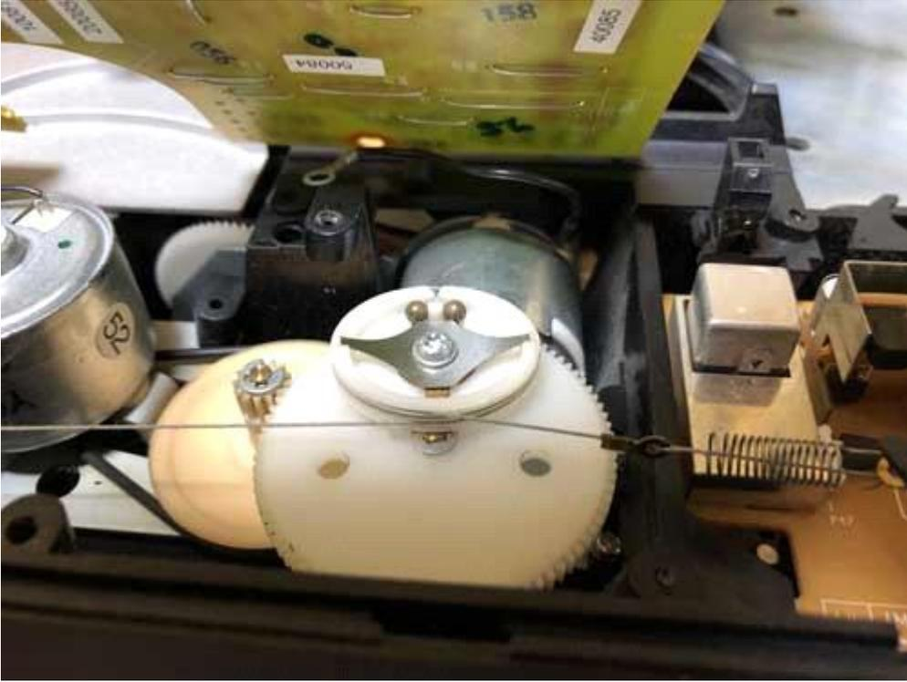
落下?の影響でワイヤー部分がキンクしてしまい、一部が断線している。
