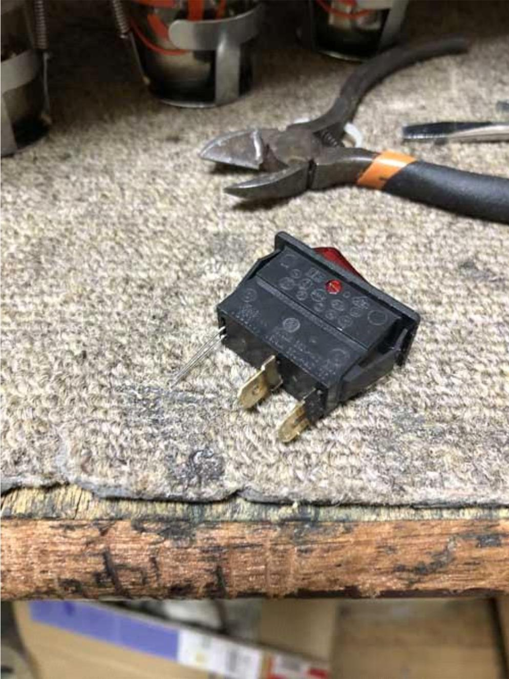
配線をして電源投入時に点灯するようにする。
