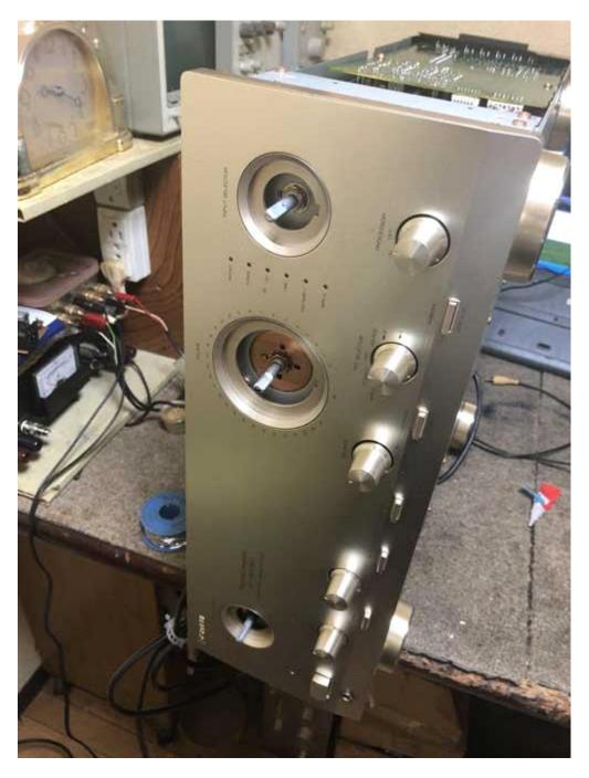
スピーカー出力基板を取り出しでリレーを外す
