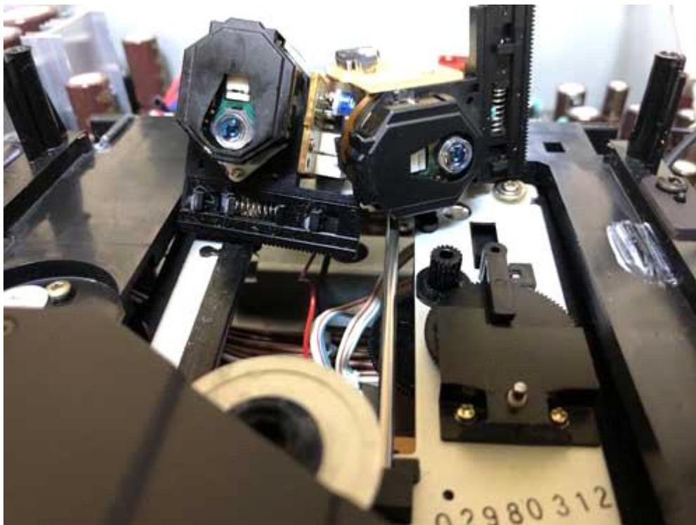
光軸調整をしてCDをセットし再生する事を確認。
